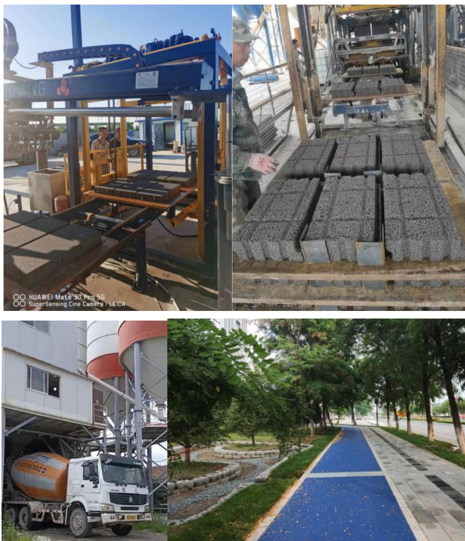
图 56 四平本地生产的透水混凝土基层、透水沥青等
